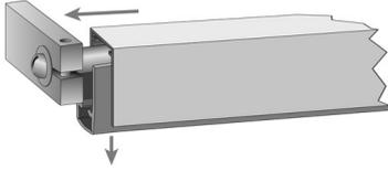
Déclenchement inversé (déclenchement en traction), plaque de traction 20 x 8 x 70 mm, pour Planet HS, FT, RH, RF, RO, RS, PU, GH, TW, US
