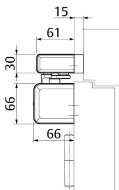
Pour le montage du bras glissière sur les portes à recouvrement
